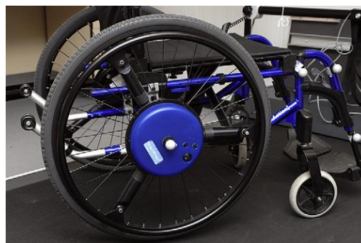
Figure 5 : Roue instrumentée Smartwheel (Three Rivers Holdings, Inc, Mesa, Arizona, États-Unis)
