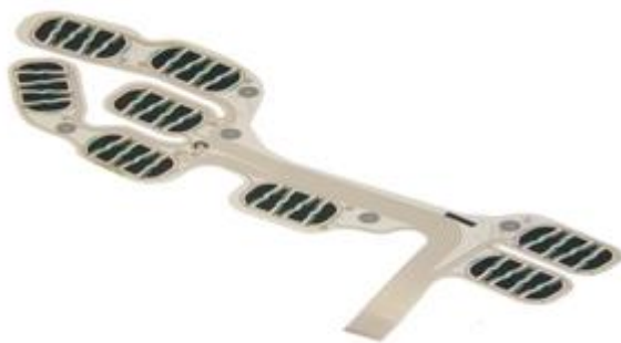
Figure 8 : Semelle de pression plantaire avec huit capteurs de pression et le boîtier émetteur, IEE®.
