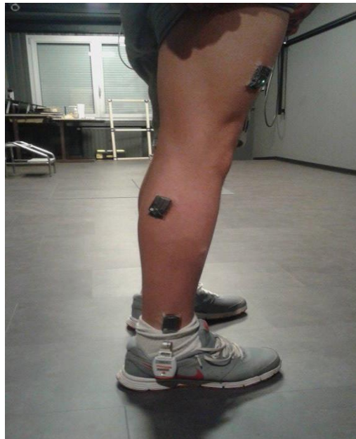
Figure 7 : Positions des électrodes EMG DELSYS et de l'accéléromètre tridimensionnel (vue de profil).
